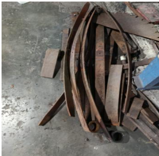
Gambar 1. Foto bahan per bekas dari kendaraan dan kegiatan pembuatan Pisau dan Golok Sumber: Dokumen M. Darmada 2025
