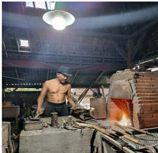
Gambar 1. Foto bahan per bekas dari kendaraan dan kegiatan pembuatan Pisau dan Golok Sumber: Dokumen M. Darmada 2025
