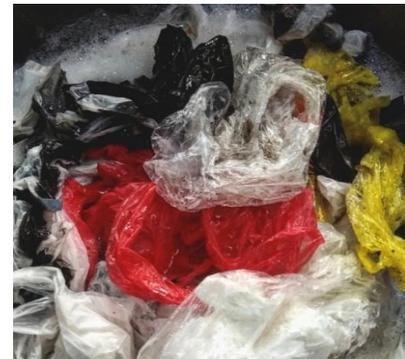
Gambar 2. Proses pencucian sampah plastik yang sudah dipilah, untuk menghilangkan bekas tanah dan kotoran yang menempel pada sampah plastik
