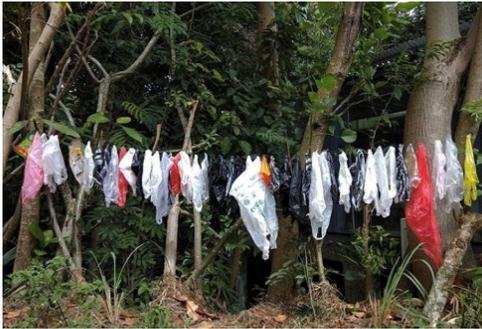
Gambar 3. Proses pengeringan sampah plastik yang habis di cuci untuk dapat dilakukan proses pengepresan dan pembuatan lembaran plastik sebagai bahan produk.
