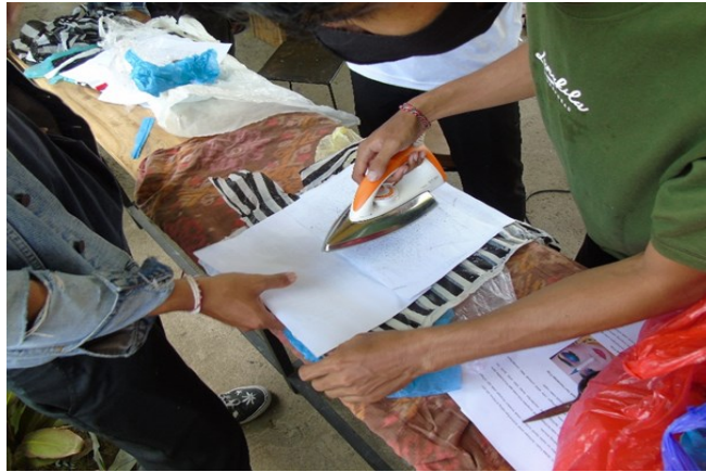
Gambar 4. Teknik pengolahan sampah plastik menggunakan teknik press Sumber (pendidikan seni rupa UPMI)
